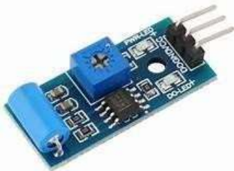
Fig: Vibration Sensor
