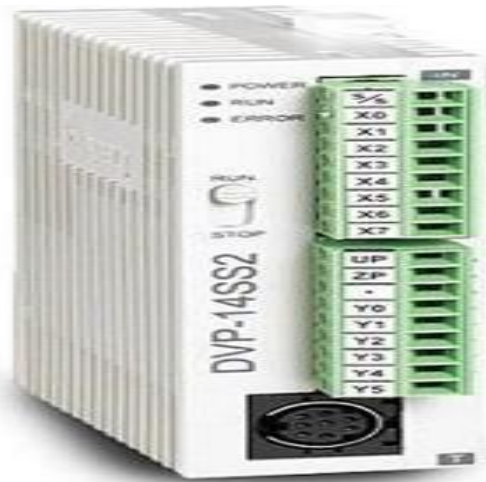
Figure9: Delta PLC ( DVP14SS2)
