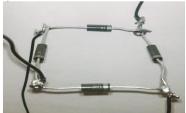
Fig .5. Bridge Rectifier.
