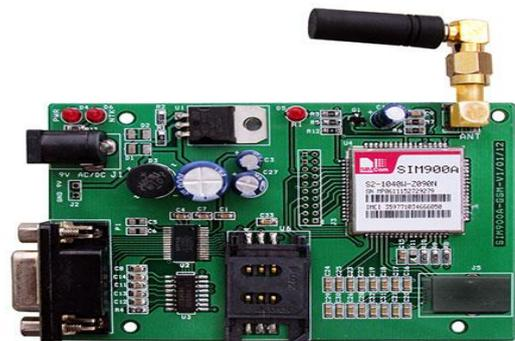
Fig. 3 GSM Module.
